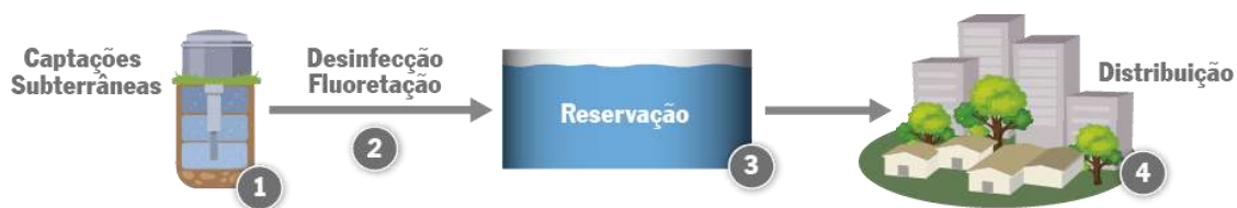
Figura 4-3 – Fluxograma do sistema de abastecimento.
