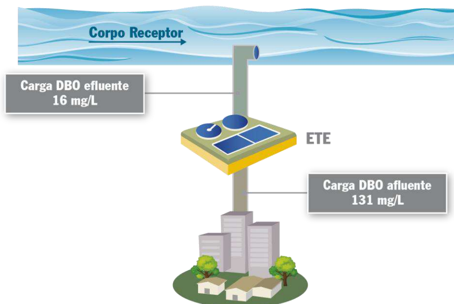
Figura 5-24 – Monitoramento SABESP - Efluentes (28/02/2020) Fonte: Adaptado de SABESP (2021)
